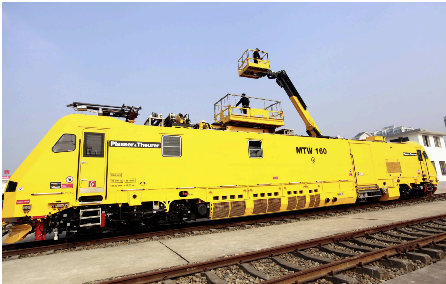
12月24日,四川省成都市,我国首台时速160公里接触网多功能综合作业车(俗称“高铁救护车”)亮相。日前,该作业车正式装备成都铁路局成都供电段,作为成绵乐客运专线接触网检修、维护和抢险专用设备。这是当今世界技术最为先进、运行速度最快、功能最为综合、用途最广泛的快速接触网综合作业车。 CFP供图
